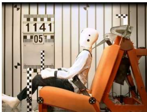
Рис 2б. Время 51 мсек. Манекен и положение ремня во время фазы нагрузки.
