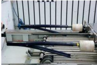
Требуемое замедление во время удара обеспечивается за счет внедрения двух металлических штырей с наконечниками особой формы внутрь разрезных полиуретановых труб, которые вставлены в трубы металлические, вмурованные в бетон
