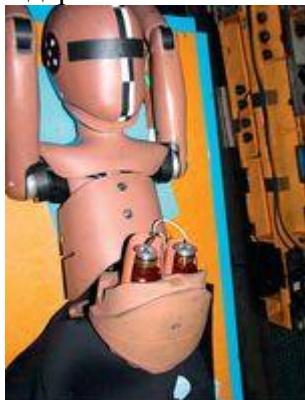
Для определения нагрузок на живот фирма Renault использует Q-манекен с экспериментальными датчиками- «колбами», которые регистрируют давление в брюшной полости
