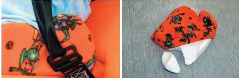
Рывок ремня отломал одно из маленьких пенопластовых фиксирующих «ушек»
