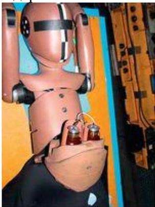
Для определения нагрузок на живот фирма Renault использует Q-манекен с экспериментальными датчиками- «колбами», которые регистрируют давление в брюшной полости
