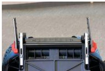
Боковые тесты на фирме Britax-Roemer проводят на скорости 25 км/ч, разворачивая «евродиван» с манекеном на платформе на 80°. Крепления Isofix хоть и гнутся при боковом ударе, зато снижают нагрузки на ребенка за счет большей стабильности кресла
